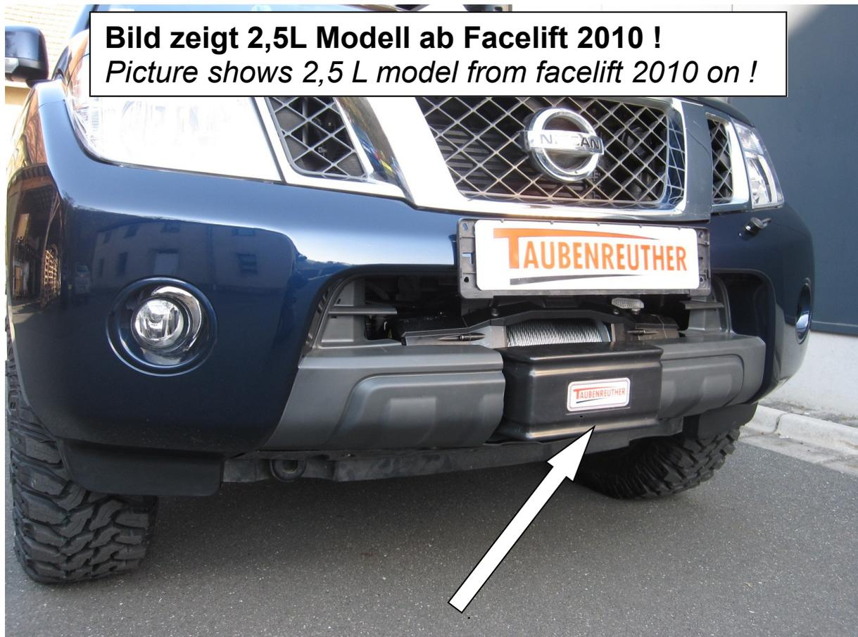
Hier sehen sie den fertig montierten Seilwindenanbausatz.
