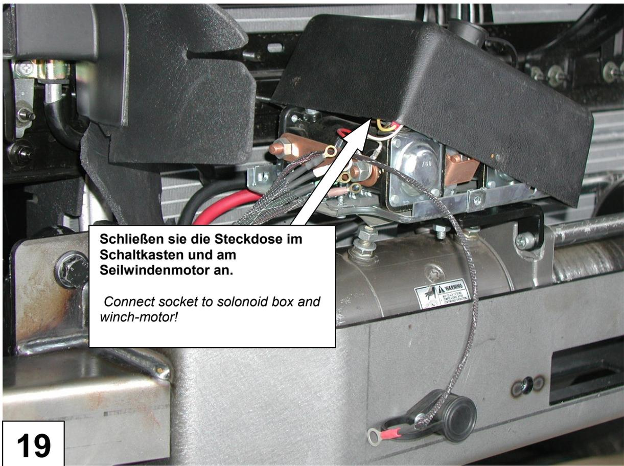
**Schließen sie die Steckdose im Schaltkasten und am Seilwindenmotor an.**
